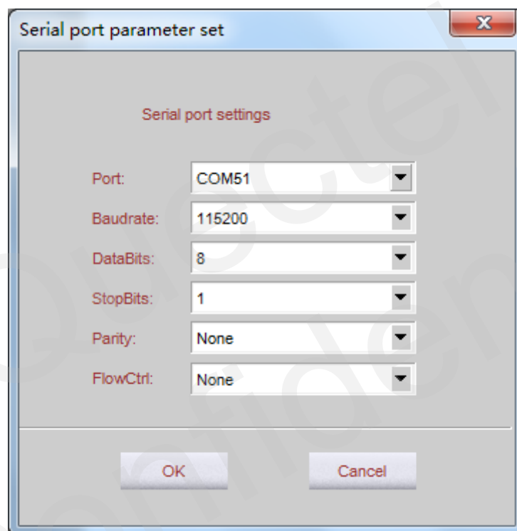
Figure 13: UART Parameter Setting
