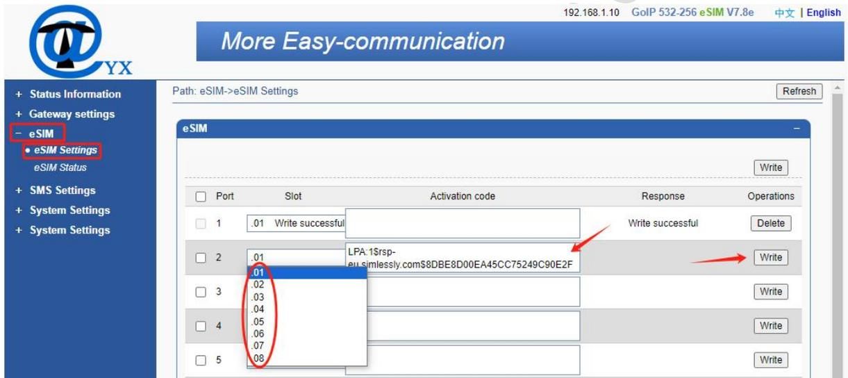
4 、eSIM 数据写入成功之后，可以在“eSIM>eSIM 状态”看到的绿色 ICCID 码，即可进行正常使用。
